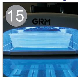
Опускаем в воду с растворённой специальной солью и засвечиваем 360 сек. для удаления липкости
