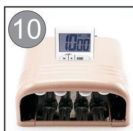
Включаем экспокамеру на 10 сек. отслеживаем с помощью выносного таймера
