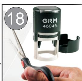
Вырезаем готовое клише с помощью прорубки или ножниц и наклеиваем на оснастку
