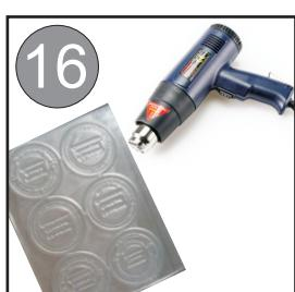
Проводим термообработку интенсивным потоком горячего воздуха 10-15 мин. (дает формирование края букв и символов)
