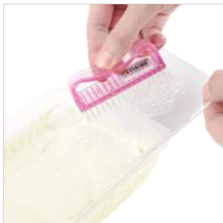
Рис.15 Ручная промывка фотополимерной пластины с клише штампов
