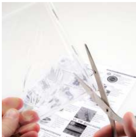
Рис.14а Контурная обрезка засвеченной пластины
