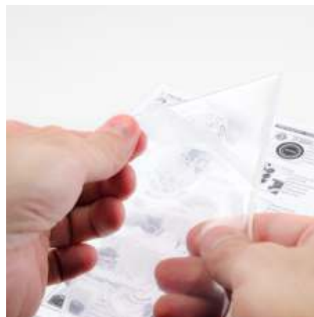
Рис.14б Отделение тонкой пленки с засвеченной пластины после контурной обрезки
